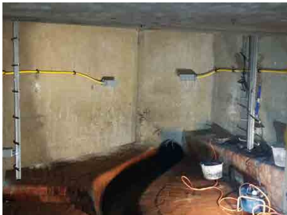
Abb. 2 Im Schacht auf der Südseite des Staukanals: Messendpunkte als Messschnecken für eine hochauflösende Höhenmessung
