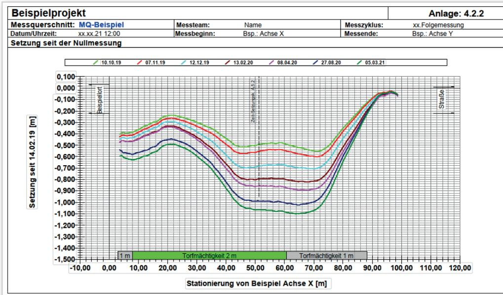
Abb. 2d Darstellung des Setzungsverlaufs anhand ausgewählter Messungen
